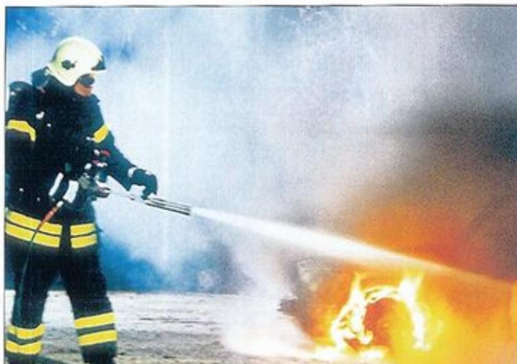
UHF 250 yüksek basınç ile tatbik edilen Ultra-ince püskürme tekniği yangın söndürme ünitesi yangını çok hızlı ve en kısa sürede etkili olarak söndürmeyi mümkün kılar.
